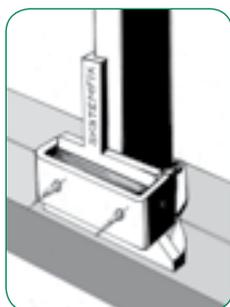
Bei Montage mit Clips muss die Schiene 3 mm vorgesetzt werden
