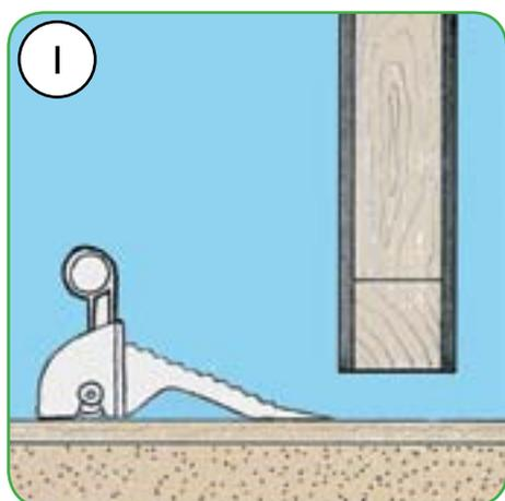
1 Positionieren Sie den Keil : Hebel oben
