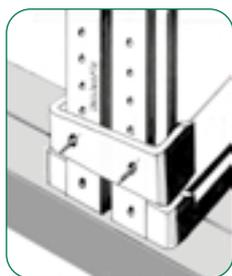
Bei Montage mit Clips muss die Schiene 3 mm vorgesetzt werden
